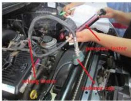
Gambar 2.4 Pemeriksaan Kebocoran Sistem Pendingin
