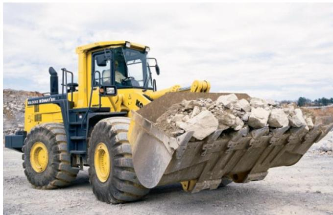
Wheel loader merupakan alat yang dipergunakan untuk pemuatan material kepada dump truck dan sebagainya. Bucket pada wheel loader digunakan untuk menggali, memuat tanah atau material yang granular, mengangkatnya dan diangkut untuk kemudian dibuang pada suatu ketinggian pada dump truck.
