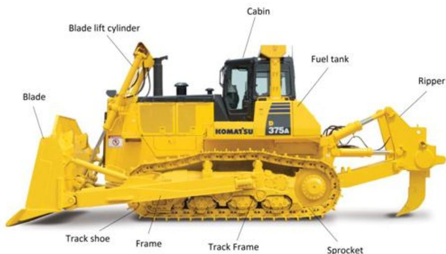
Bulldozer memiliki blade yang tegak lurus pada arah gerak maju, sedang untuk angle dozer, blade selain tegak lurus juga dapat menyerong. Bulldozer mendorong tanah ke depan, sedang angle dozer ke depan dan ke samping. Beberapa konstruksi bulldozer mempunyai blade yang memungkinkan berfungsi sebagai bulldozer, juga angle dozer, dengan cara menyetel bladenya sedemikian rupa sesuai dengan kebutuhan.
