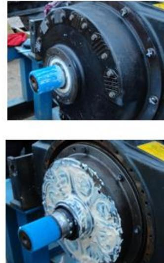
Tenaga engine dipindah ke flywheel dan outer body, kemudian rubber cushion meredam getaran engine. Tenaga engine kemudian diteruskan melalui inner body (8) ke output shaft. Dari sini, tenaga engine diteruskan melalui coupling ke torque converter. Damper tipe ini dipakai pada unit WA500, WA800, HD325, HD 785, D375A-2 dan sebagainya.
