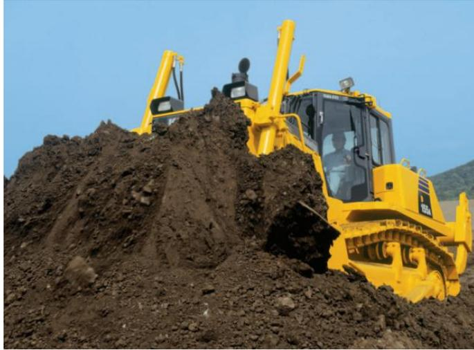
Gambar 1. Bulldozer dengan roda tipe rantai (crawler)
