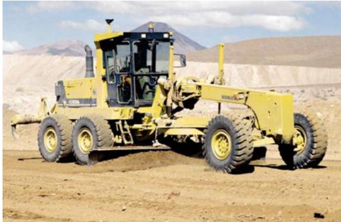
Motor Grader pada umumnya digunakan untuk pekerjaan meratakan tanah, dalam hal ini pada pekerjaan finishing, mengikis tebing atau membuat parit. Motor grader merupakan jenis peralatan yang dapat dipakai dalam berbagai variasi dalam pekerjaan konstruksi (grading). Kemampuan ini akibat dari gerakan-gerakan yang fleksible yang dimiliki terhadap blade dan roda-roda ban. Kesenyapannya ini diperbesar dengan perlengkapan-perengkapan lainnya yang ada pada motor grader seperti:
